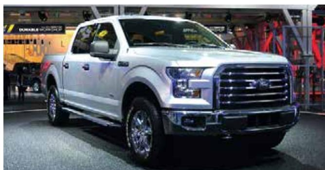
福特汽車在2014底特律車展推出了全新一代鋁制F-150皮卡。新一代皮卡採用輕量化設計，也通過發動機排量進一步提升燃油經濟性。福特總裁艾倫·穆拉利表示，鋁合金比鋼材更堅硬，鋁合金可以減少車身318千克的重量。新皮卡的特點就是“更大、更寬、更強，但卻更輕”。
